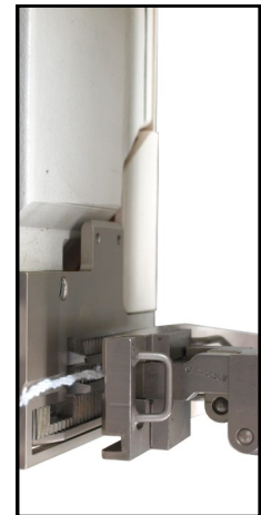
Umschlag-Verschuß von Hand durch Bediener oder durch zusätzliche Sackzuführeinrichtung mit Sackumfalteinrichtung
