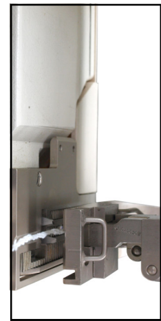
Umschlag-Verschluss von Hand durch Bediener oder durch zusätzliche Sackzuführeinrichtung mit Sackumfalteinrichtung
